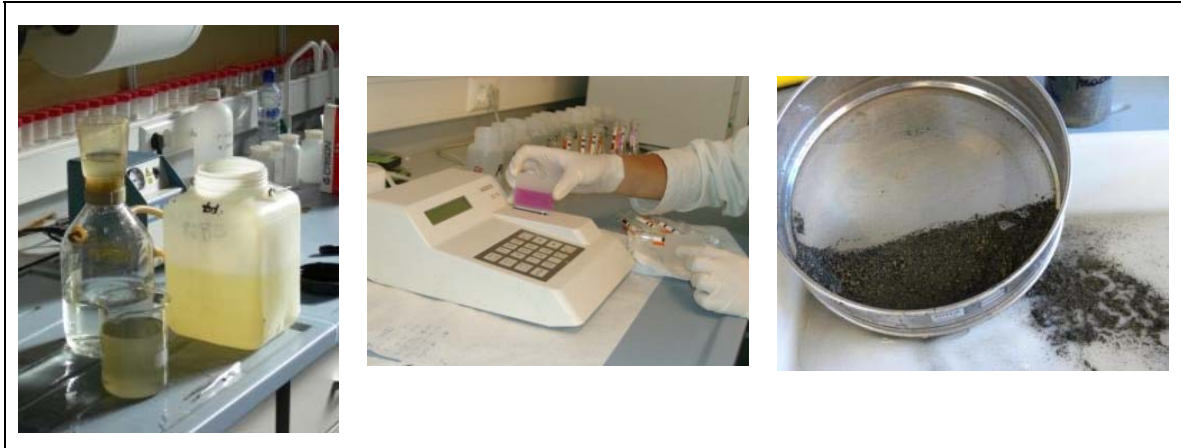
Foto 2. Anàlisi al laboratori. Filtració d'aigua (esquerra), lectura amb espectrofotòmetre (centre) i processat de mostra d'organismes (dreta).
